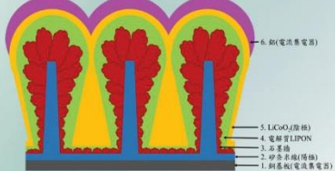
圖2. 石墨奈米包圍砂奈米線作為陽極之全固態鋰離子電池示意圖。
