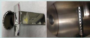
圖5. 不銹鋼Holder、Holder圓形固定桿
